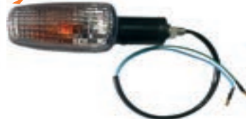
REF: 206515 DIRECCIONAL HONDA XRE300 MV DEL DER-TRAS IZQ TRANSP
