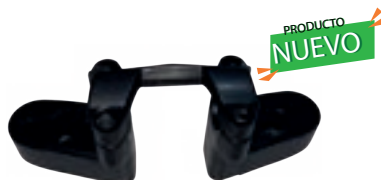
REF:207340 BASES MANUBRIO BAJAJ PULSAR NS200 FI ABS DC BARRAS INVERTIDAS (ALUMINIO INYECTADO)
