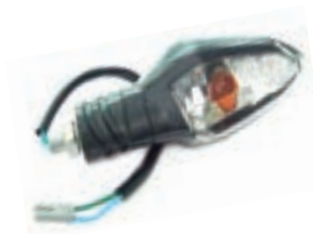
REF: 206277 DIRECCIONAL BAJAJ DISCOVER 125 ST-150ST DEL DER-TRAS IZQ- TRANSP
