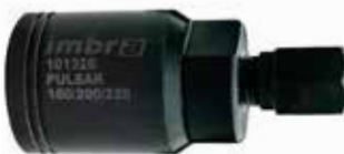
REF: 101326 EXTRACTOR VOLANTE BAJAJ PULSAR 25/180/200/220 Rosca M28X1.25p izquierda/PULSAR NS125 CARBURADA MOD 2022/NS 160FI/NS 180FI/NS160
